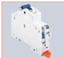
Bornes à connexion rapide sur les disjoncteurs de 2 à 20A. Deux bornes de connexion indépendantes par pôle. La forme évasée de la borne facilite l'insertion du fil. Jauge frontale pour la longueur de fil à dénuder. Test tension sur chaque borne.
